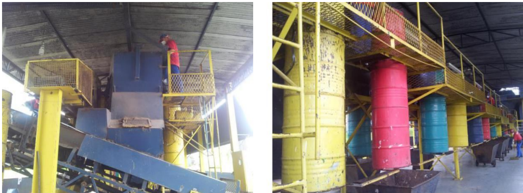
Figura 8 Esteira elevada para triagem manual de resíduos
