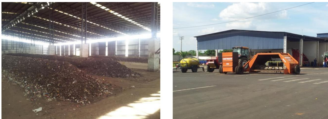
Figura 10 Pátio de decomposição da fração orgânica e máquina para revolvimento das pilhas
