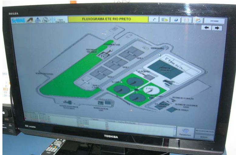
Figura 81 Tela do supervisorio da ETE: fluxograma
